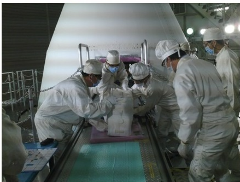
図4. 宇宙へ打ち上げる試料を梱包している様子。上、中：種子島の JAXA の施設内で、3 箱の打ち上げ用試料は、この実験のために特別に制作された保冷箱及び保護箱に詰められた。下：H2B ロケットの先端（後ろに見える白い円錐状のも）に試料が収納された。
